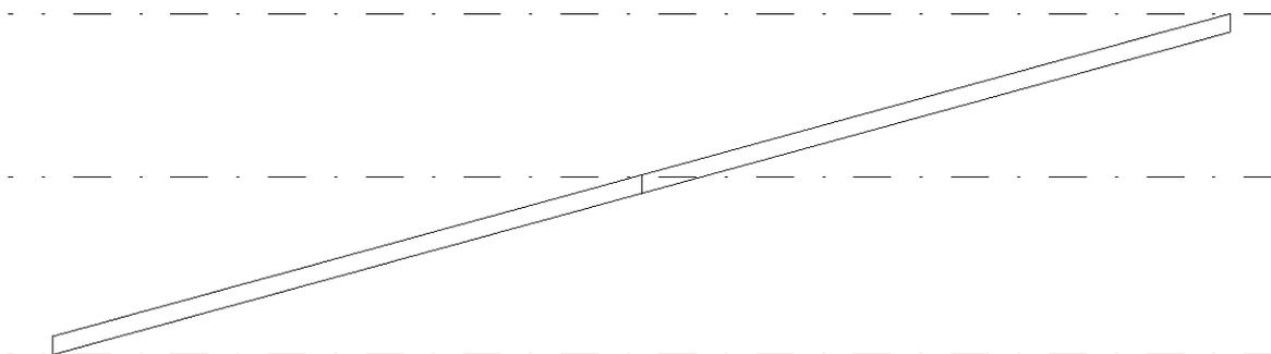
3. Si consiglia di evitare di modificare sub elementi per creare inclinazioni, perché quest'azione può compromettere la geometria del solaio descritto come parallelepipedo. Invece, per costruire solai inclinati bisogna inserire un'inclinazione alla famiglia solai.
