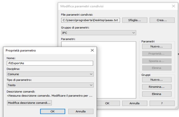
Dopodiché dobbiamo inserire il parametro condiviso creato con parametro nel progetto d'esempio. Quindi selezioniamo **Gestisci > Parametro del progetto > aggiungi e selezioniamo il file con estensione .txt** che abbiamo creato anteriormente ed il parametro "ifcExportAs". Lo applicheremo alla categoria PAVIMENTI, assicurandoci che venga caricato ed accettiamo.
