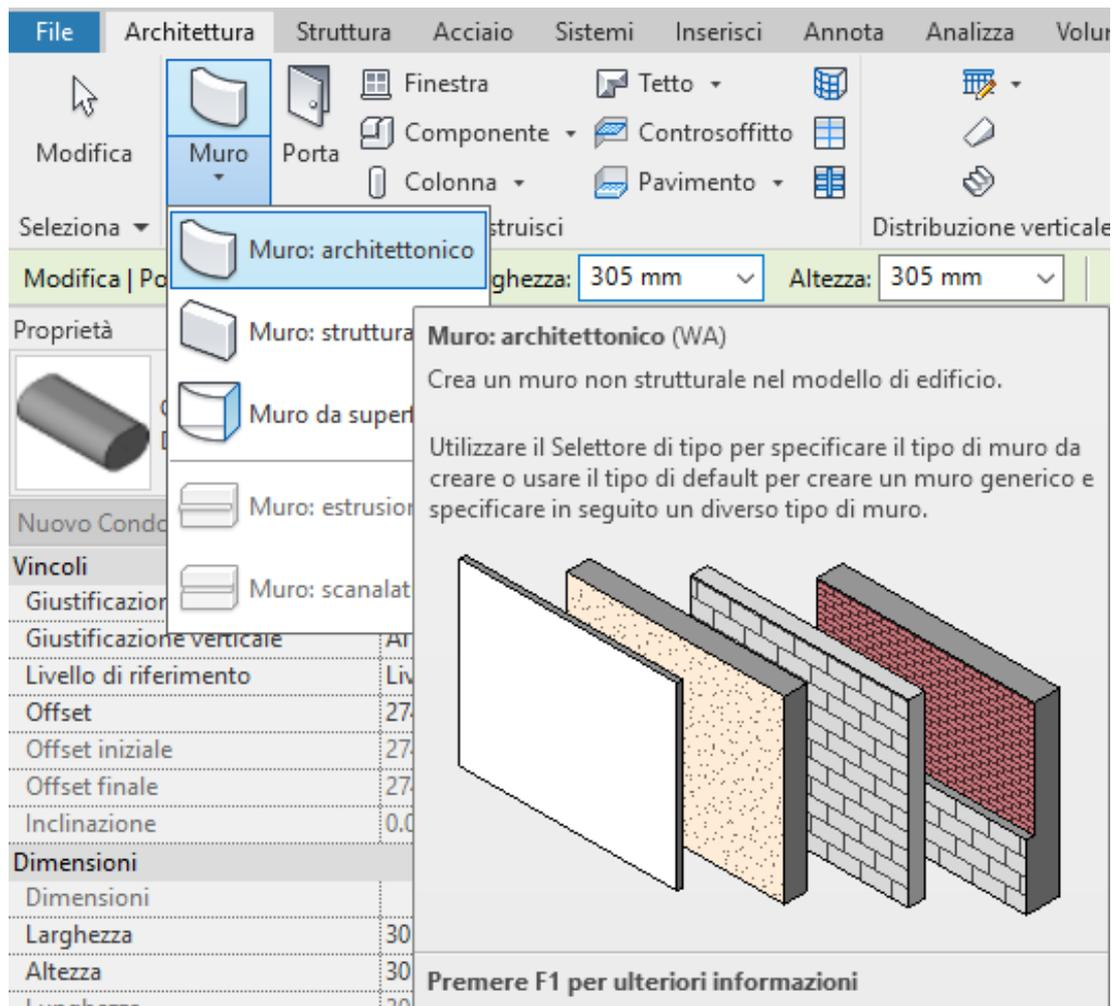
6. Impostare correttamente la definizione del parametro Funzione (interiore/esteriore) dipendendo se i muri siano tramezzi o a chiusure verticali (per essere letti correttamente nei programmi di calcolo termico o acustico).
